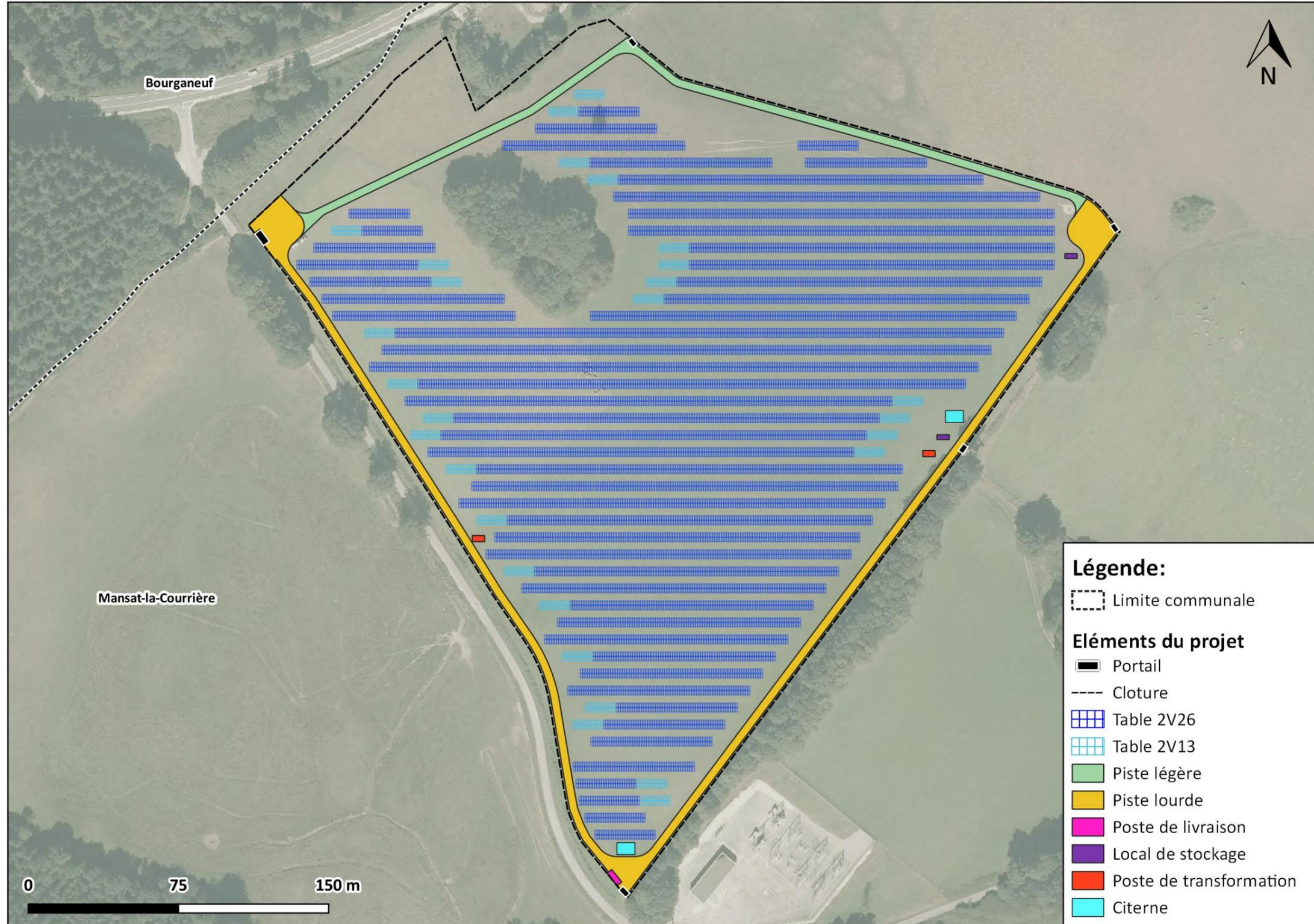
Figure 6 : Implantation finale de la centrale photovoltaïque au sol à Mansat-la-Courrière
