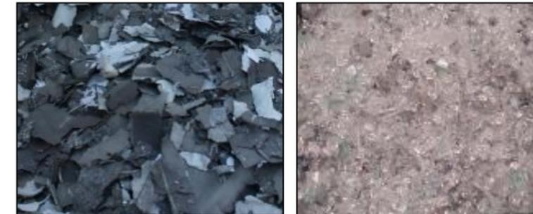
Figure 13 : Fragments de silicium et granulés de verre (Source : Soren, photovoltaïque.info)
